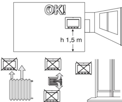
Installare preferibilmente il termostato a quota  $1,50 \div 1,60$  m dal pavimento; lontano da sorgenti di calore, prese d'aria, porte o finestre e da quanto possa influenzarne il funzionamento.
