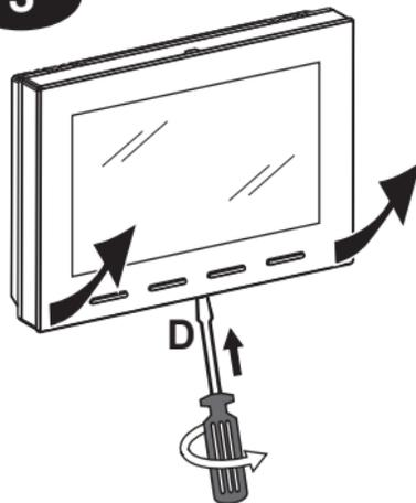
Sganciare il termostato dalla base a parete premendo con un cacciavite nell'apposita cava D presente nella parte inferiore del dispositivo, quindi estrarlo.
