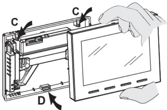
Rimozione del termostato
