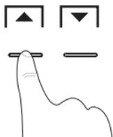
Il manuale temporaneo si attiva tramite la variazione del set di temperatura con la pressione dei tasti a freccia ▲▼: sul display compare il simbolo
